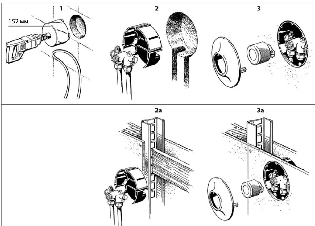
Клапаны FHV одинаково подходят для монтажа как на несущих стенах, так и на перегородках. Для удобства монтажа регулирующих клапанов FHV служит компактная настенная коробка для размещения корпуса клапана, которая может быть смонтирована и закреплена в полой нише в стене любого типа.
